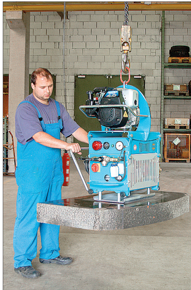
Appareil de base avec générateur et paquet de sécurité avec suspension pour l'utilisation du matériel de levage.
