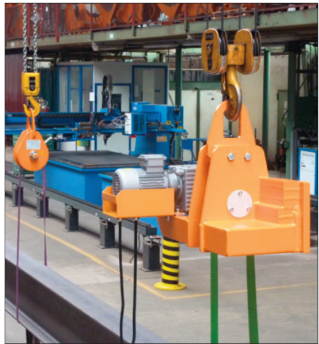
422 584 / 422 585: Wendegerät WTE 2,0 mit Wendetrommel WT 1,0, Gesamttragfähigkeit 3 t
