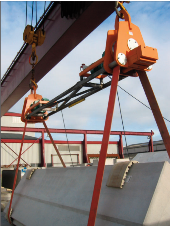
422 556: Zwei Wendegeräte WG 12,5 mit Distanzrahmen, Gesamttragfähigkeit 25 t
